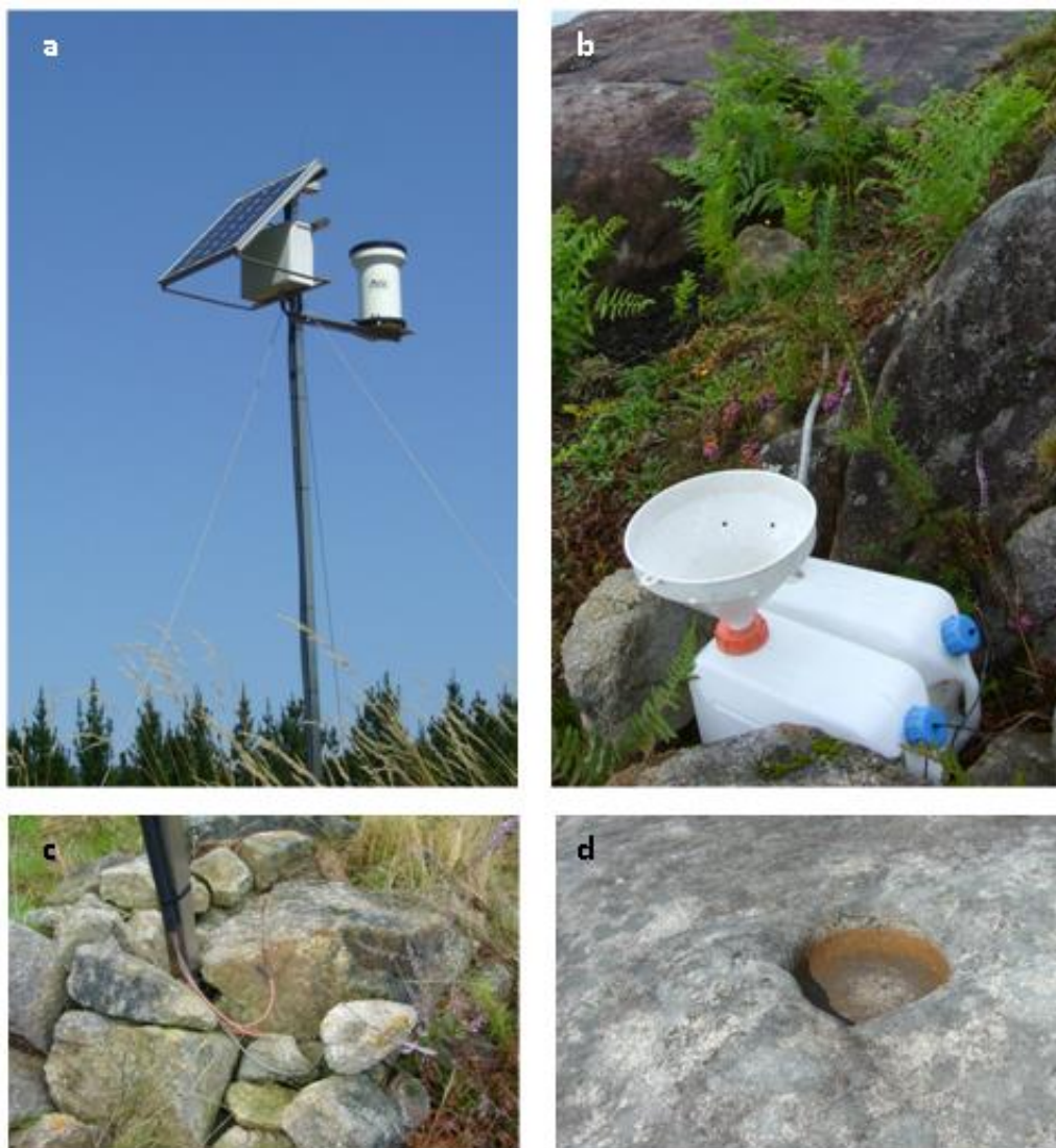
Fig. 2. (a): Datalogger y pluviómetro de balancín en la estación de Ventaniñas; (b): colectores de recogida de la deposición total y la escorrentía; (c): sensores para medir la temperatura superficial de la roca; (d): cazoleta natural (pía) en el petroglifo de Forneiriña con el fondo revestido de oxihidróxidos de Fe. Fotografías de Beatriz Prieto y Benita Silva.
